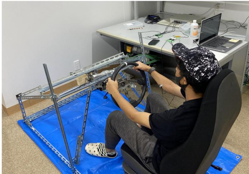
図2 製作したドライビング装置と実験風景
