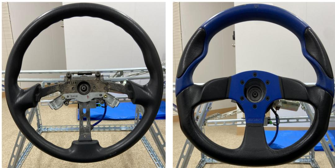
図1 本研究で用いたステアリングホイール(左から円形、D型)
