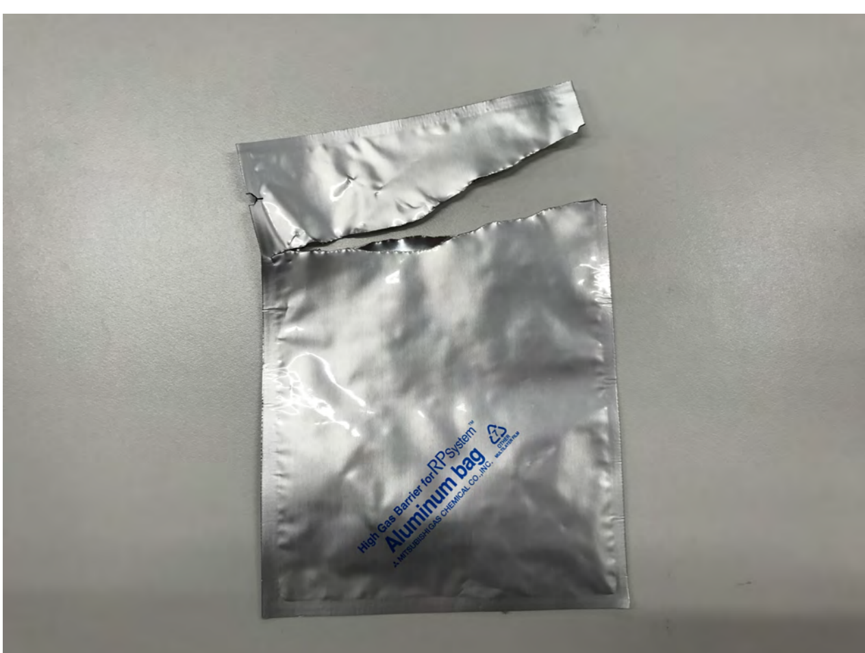
図2 切り口がずれて上部が切り離せなかったパウチ
